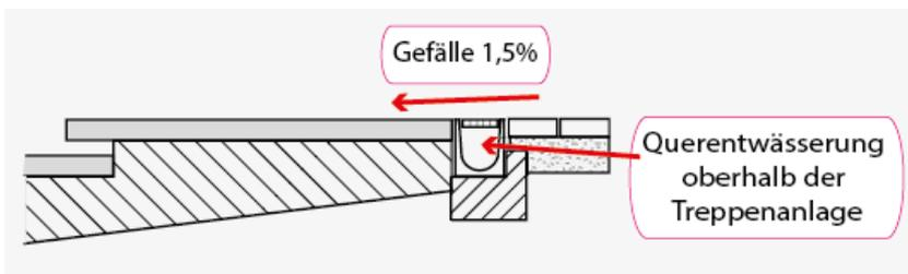
Zur Minimierung der anfallenden Wassermenge wird oberhalb der Treppe gegebenenfalls der Einbau einer Quertwässerung, z. B. in Form einer Kasten- oder Schlitzrinne, empfohlen. Ansonsten besteht Gefahr, dass übermäßig viel Niederschlagswasser in die Stufenkonstruktion eindringt und ggf. zu Feuchtflecken oder sogar zu Frostschäden führt.
