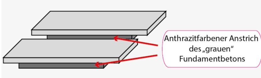
Aus ästhetischen Gründen kann der Fundamentsockel farbig behandelt werden. So „verschwindet“ mit einem anthrazitfarbenen Anstrich das Fundament im Schatten der darüber liegenden auskragenden Platte.
