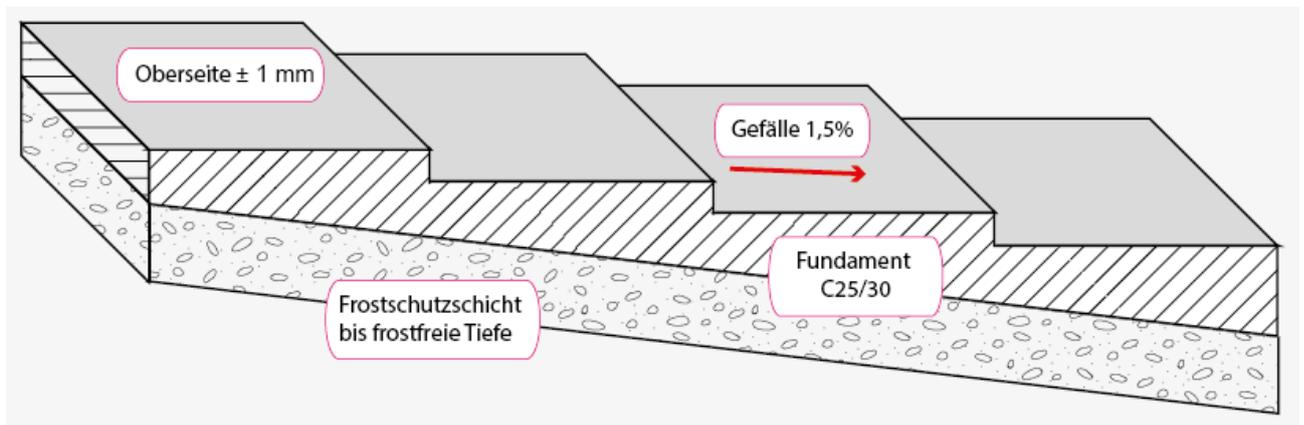
Das Fundament wird an seiner Unterseite nicht abgetreppelt, es liegt auf dem schrägen Planum auf. Die Tiefe und Breite beträgt die der Stufenplatte abzüglich der jeweiligen Auskragungen. Die Höhe der einzelnen Abtreppungen ist so groß wie die gewählte Steigung der einzelnen Stufen. Zudem muss auch die Fundamentoberseite das gleiche Gefälle wie die Stufenplatte von aufweisen.
